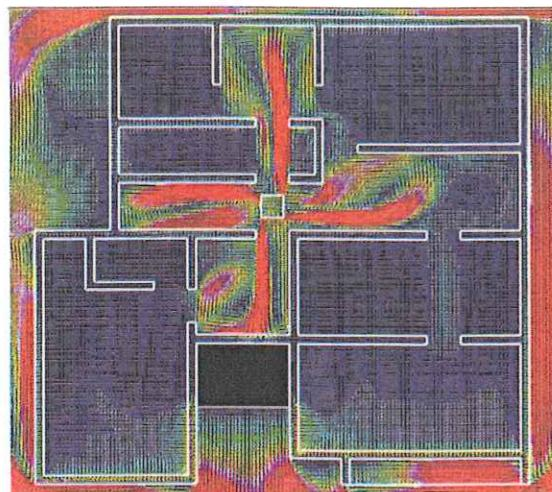
攪拌送風による床下内部の通風シミュレーション
