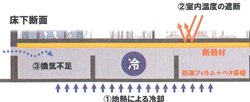
床下の相対湿度は、夏季などの温暖な時期に上昇します。それは床下底面のコンクリートが地熱で冷やされるほか、断熱材による室内側温度の遮断や、日射と換気が届かないことによる床下温度(特に中央部)の低温化が原因です。
