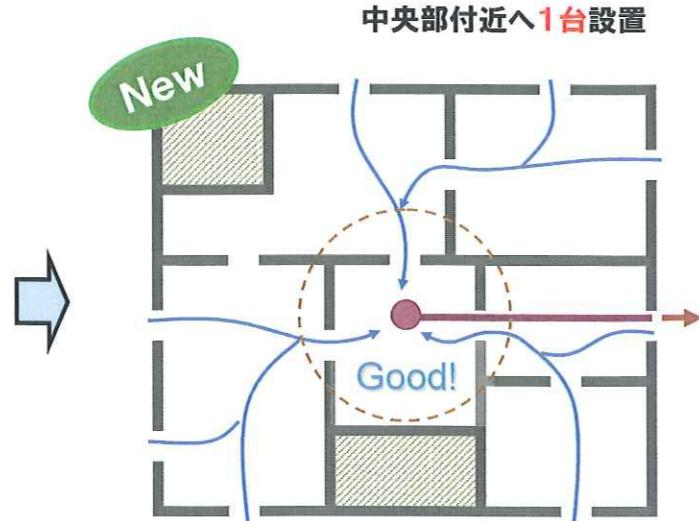
弊社が提唱する新方式は、床下中央部へ換気ユニットを設置し、高湿な空気を直接ダクトで排出するものです。基礎の全周から外気が流入するため、基礎パッキンとの相性も良くショートカットも発生しません。床下外周部の換気はパッキンによる自然通風を利用する考え方なので、20坪程度までなら1台のみの設置で防湿効果を発揮できます。
